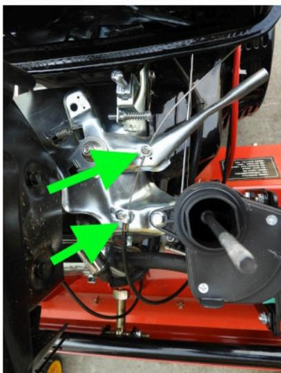
ネジが緩んでいる場合はワイヤーの出具合を調整してからネジを締めてください。エンジンを切った状態で、スロットルを [H (高回転)] まで動かして [S (スタート)] に戻した際にワイヤーが余りなく戻る状態が通常です。調整ができたならエンジンを始動して回転が変わるか確認してください。
