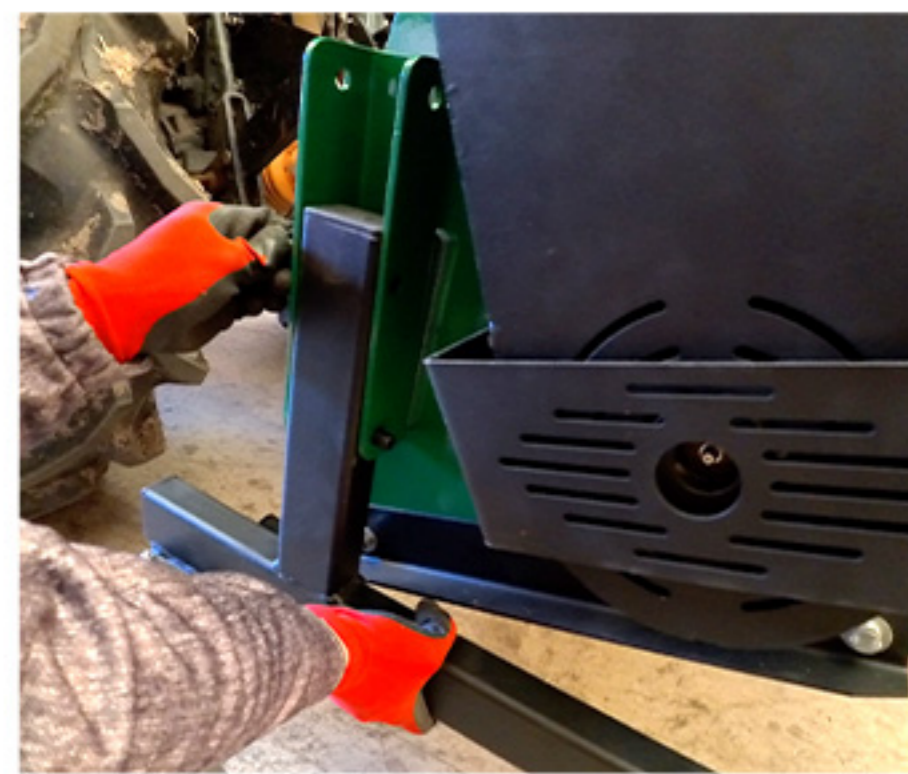
ロックをすることでロアジョイントも固定されます
